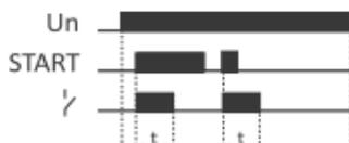
La génération d'une seule impulsion de la durée «  $t$  » par le front montant du signal **START**. Pendant la temporisation, le système ne répond pas aux impulsions **START**.
