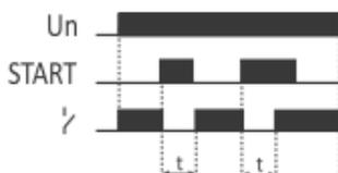
La désactivation du relais pour une durée réglée « **t** » par le front montant du signal **START**. Pendant la temporisation, le système ne répond pas au signal **START**.
