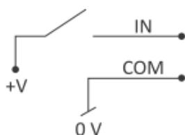
Attivazione tramite il livello di alta tensione
