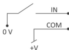
Attivazione tramite il livello di bassa tensione
