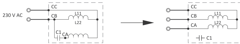
Typisches Diagramm eines Einphasenmotors mit Anlaufkondensator
