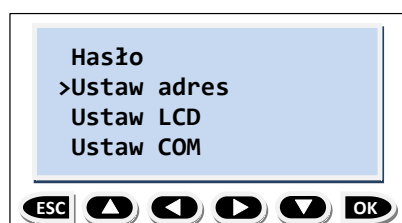
3.5-9 Ekran konfiguracji urządzenia (zmiana adresu urządzenia pracującego w sieci)
