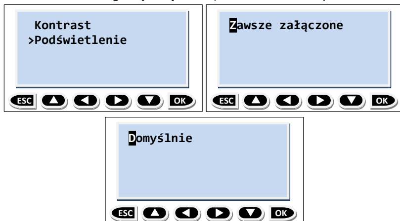
3.5-14 Ekran konfiguracji urządzenia (zmiana sposobu podświetlenia wyświetlacza LCD)
